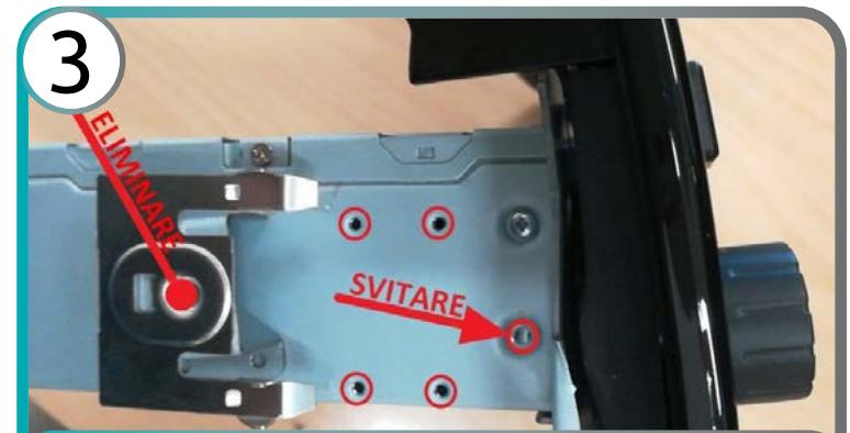
Eliminare le clip di fissaggio. Svitare viti basse che fissano il corpo radio
